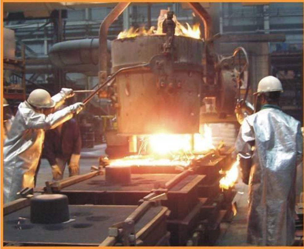
Ladel Bottom Up Pouring
